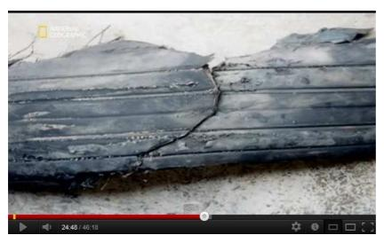
Die französischen Ermittler finden mehrere <u>Reifenteile auf der Startbahn</u>. Eins davon wiegt <u>viereinhalb Kilo</u>. Tests bestätigen schnell, daß sie zu der <u>Concorde</u> gehören. Das ist eine bedeutsame Spur. Weshalb? Die Reifen der Concorde werden bis einem extrem hohen Druck aufgepumpt, was dazu führt, daß sie leichter platzen als bei anderen Flugzeugen, vor allem bei den Starts und Landungen ...
